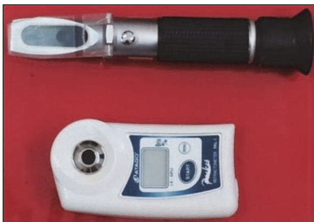
شکل ۳۲- رفاکتومتر دستی (بالا) و دیجیتال (پایین) برای اندازه‌گیری درصد کل مواد جامد محلول
